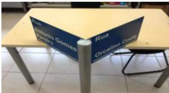
1. As placas serão sustentadas por um suporte de aço galvanizado a fogo, medindo 3,50cm comprimento, com 2½” de diâmetro, e espessura da parede de 2mm, com elementos para fixação (abraçadeiras e parafusos com porcas galvanizados a fogo) e tampão na parte superior para evitar entrada de água.
