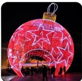
Figura em formato de bola com duas portas medindo 3,00m x 3,00m estruturada em barra de ferro chato 3/8 x 1/8 de polegada, pintada na cor branca ou zincada com proteção anticorrosiva resistente a aplicação de cordão de led e contornado por mangueira de 10mm, de uso externo, 2 fios, com isolamento antichama, 220v, 60hz, com 24 leds por metro dispostas na vertical em relação ao eixo longitudinal da corda, min 3w/m.
