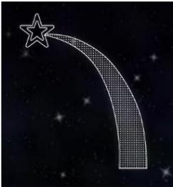
Instalação de arcos com estrela na ponta, em estrutura de ferro e/ou metalão. O arco medindo 1,5 metro de lateral e 2,5 metros de altura, a estrela com 5 pontas medindo 0,50 metro de largura e 0,50 metro de altura. Arcos e Estrelas Preenchidos com micro lâmpadas na cor branco quente e contornados em mangueira de led branco quente, fixados ao chão, todo material blindado para uso externo a prova d'água.
