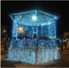
Instalação de 06 refletores de led 100w no telhado, contorno de toda grade de proteção e do beiral do telhado com Cascata com 400 leds, fio branco, bivolt, para uso externo, 31v, tomada m/f, fonte separada e blindada da tomada/pino. 64 caídas: 70cm, 50cm, 30cm, comprimento: 10m, potência: 15w, IP44. 06 guirlandas de 50cm instaladas nos pilares com laço, bolas e pisca pisca.
