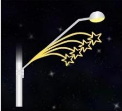
Tamanho – Altura 1,75 x 0,75m de largura. Figura luminosa bidimensional com desenho em forma de 3 curvas e duas estrelas, sendo uma em cada ponta da curva, produzida em ferro de 1/2 x 1/8 polegadas, zincado, com proteção anticorrosiva resistente a exposição prolongada em áreas externas. Aplicação de mangueira luminosa em led, em pvc flexível extrudado. Tensão 220v.
