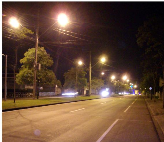
Figura 21 – Via coletora com canteiro central iluminada com luminárias integradas e lâmpadas a vapor de sódio 250W. Fonte: COPEL (2011).
