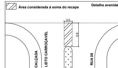
04. DETALHE DA EXTREMIDADE DO CANTEIRO ESC: 1/50
