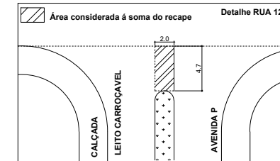
05. DETALHE DA EXTREMIDADE DO CANTEIRO ESC: 1/50
