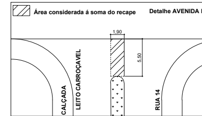
04. DETALHE DA EXTREMIDADE DO CANTEIRO ESC: 1/50
