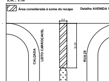
05. DETALHE DA EXTREMIDADE DO CANTEIRO ESC: 1/50
