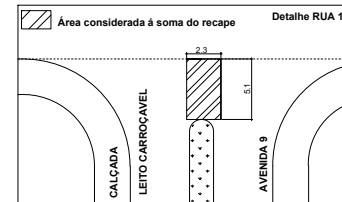
05. DETALHE DA EXTREMIDADE DO CANTEIRO ESC: 1/50
