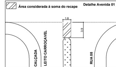
**05. DETALHE DA EXTREMIDADE DO CANTEIRO**
