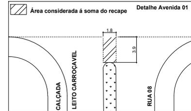
**05. DETALHE DA EXTREMIDADE DO CANTEIRO**
