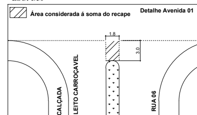
04. DETALHE DA EXTREMIDADE DO CANTEIRO ESC: 1/50
