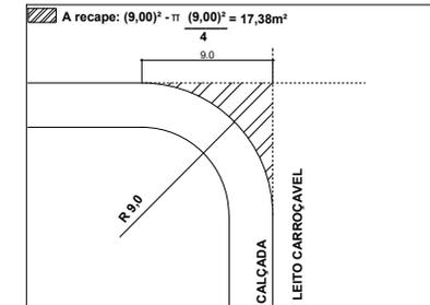
**05. DETALHE DA EXTREMIDADE DO CANTEIRO**
