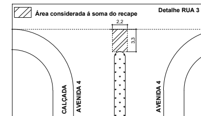
06. DETALHE DA EXTREMIDADE DO CANTEIRO ESC: 1/50
