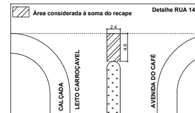
**06. DETALHE DA EXTREMIDADE DO CANTEIRO**
