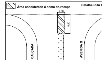
06. DETALHE DA EXTREMIDADE DO CANTEIRO ESC: 1/50
