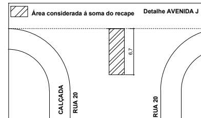
05. DETALHE DA EXTREMIDADE DO CANTEIRO ESC: 1/50
