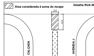
06. DETALHE DA EXTREMIDADE DO CANTEIRO ESC: 1/50
