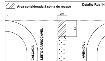
06. DETALHE DA EXTREMIDADE DO CANTEIRO ESC: 1/50
