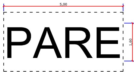
REPRESENTAÇÃO ESQUEMÁTICA DA SINALIZAÇÃO HORIZONTAL DE ADVERTÊNCIA DAS VIAS PÚBLICAS ESCALA 1:100
