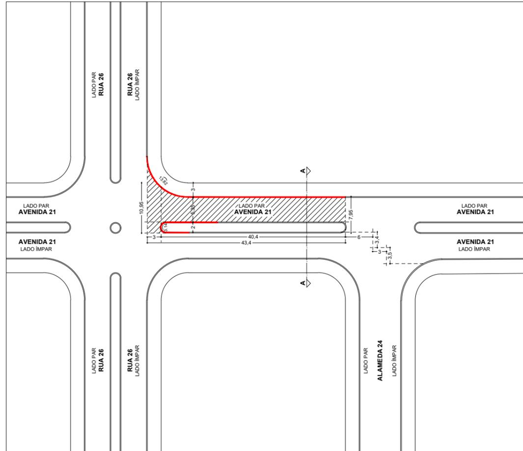
03. DETALHE DA PAVIMENTAÇÃO ASFÁLTICA
