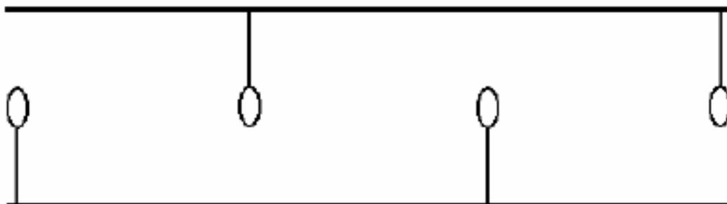
Figura 4 – Arranjo bilateral alternado das luminárias.
