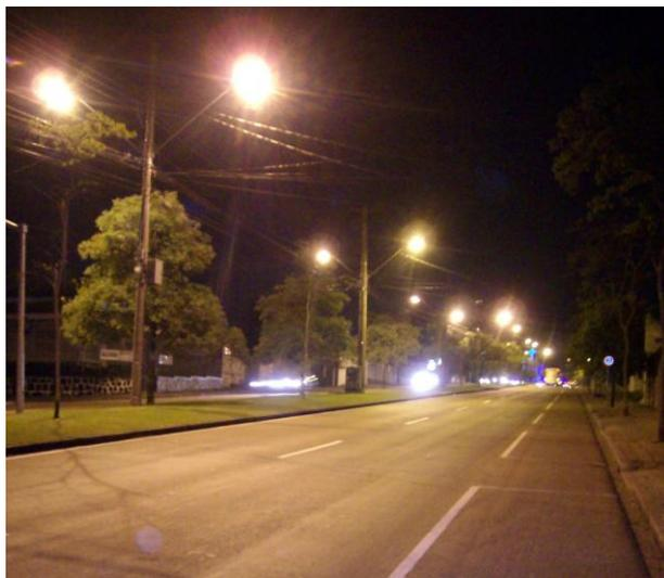
Figura 21 – Via coletora com canteiro central iluminada com luminárias integradas e lâmpadas a vapor de sódio 250W.
