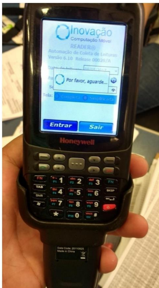
Figura 53 – Equipamento PDA para realização de leituras
