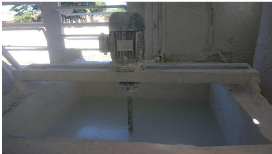
Figura 22 – Extintor de cal
