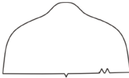
Figura 8 – Contraforte para melhor conformação
